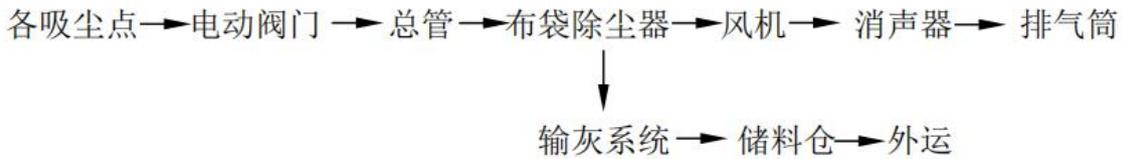
图 4.2-1 上料除尘系统工艺流程图
