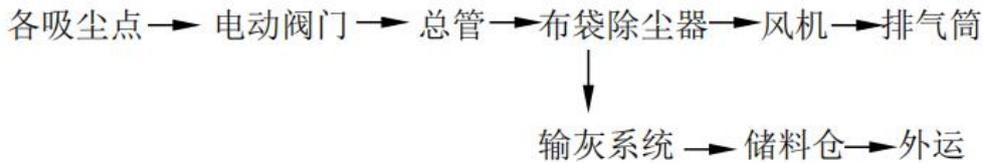
图 4.2-3 破碎除尘系统工艺流程图
